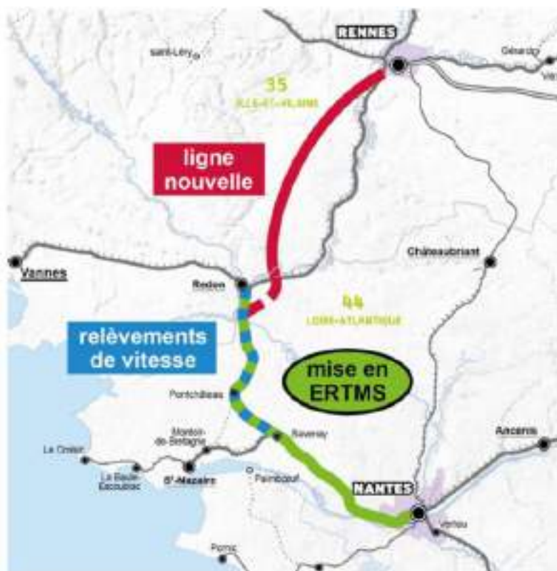
Figure 7 : scénario maximal de l'axe Nantes - Rennes - Bretagne Sud (nota : représentation schématique de la ligne nouvelle). Source : SNCF Réseau
